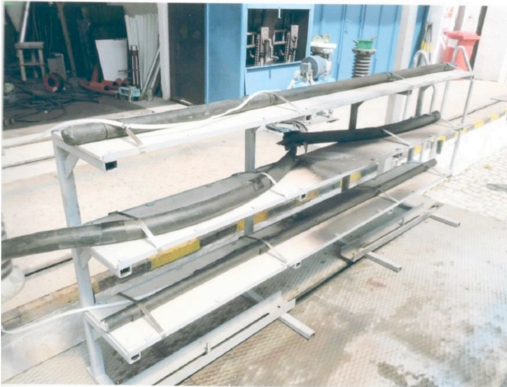
Bild 3 Prüfmuster nach der Prüfung durch Lichtbogen-Kurzschluss am Hochspannungsprüfkabel
